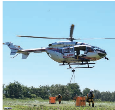
給水した消火バケツトを装着し離陸する防災ヘリ。
