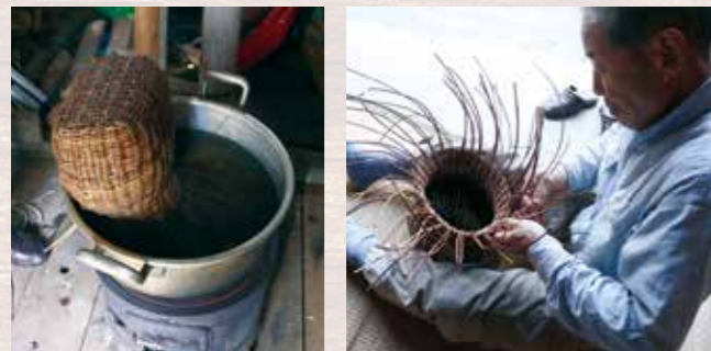
左/お湯につけてつるを柔らかくして編みやすくしています。右/自分の想像している形に近づけるためにつるをほぐしたり、もう一度お湯につけて調整します。
