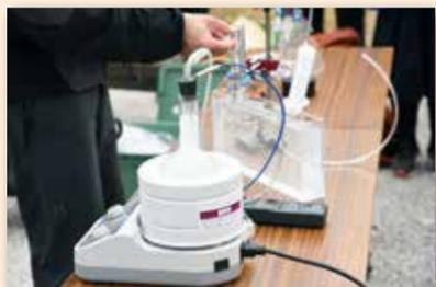
2 採取した温泉水と腐材のアルミニウムをフラスコに入れ、温度を上げて反応させます。
