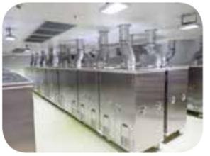
洗浄後の「食器」「食缶」「給食コンテナ」について、熱風による部屋全体の加熱・殺菌消毒を実施し、翌日の積込に備えます。
