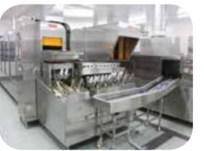
各学校より回収された「食器」「食缶」「給食コンテナ」を洗浄機で洗います。
