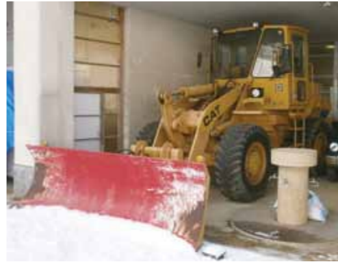
建第1号 車両(除雪ドーザー11ト級)
