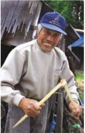
現場仕事の合間に串を作ります。串は差した茅を留めるストッパーの役割の道具。ナラの木を裂いて細くし、中心を木槌でたたいてねじりながら回転させます。女性が髪を結うときに使うUピンの要領で茅に差しします。
