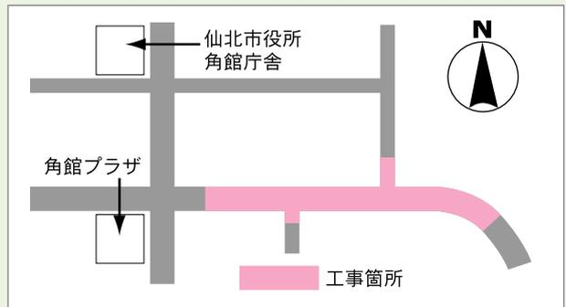
本工事は、都市計画街路横町線及び大町通線の街路工事として発注され、今回は車道の拡幅工事を行います。両側の流雪溝の施工を行い現況の舗装を剥ぎ取り、道路を掘り下げ、新たに道路を構築し舗装工事をいたします。
